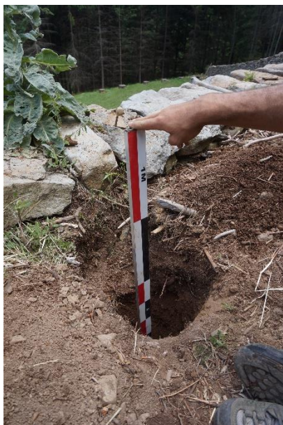
Fig. 45 : sondage de l'extrados de la voûte.
